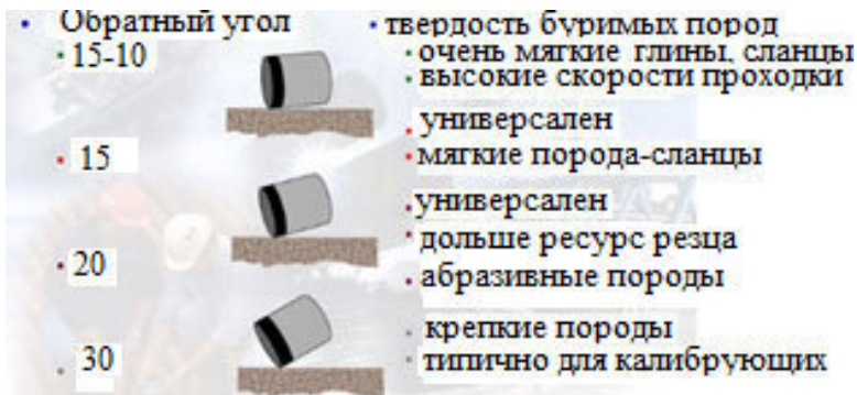
Рис. 5.13. Типовые обратные углы резания
