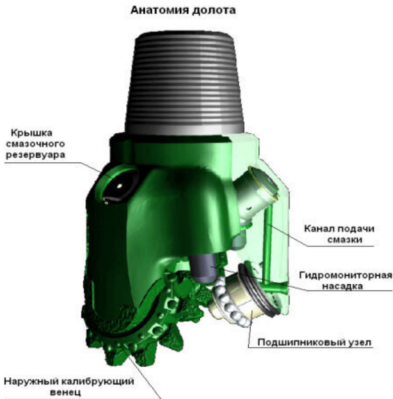
Рис. 5.1. Шарошечное долото
