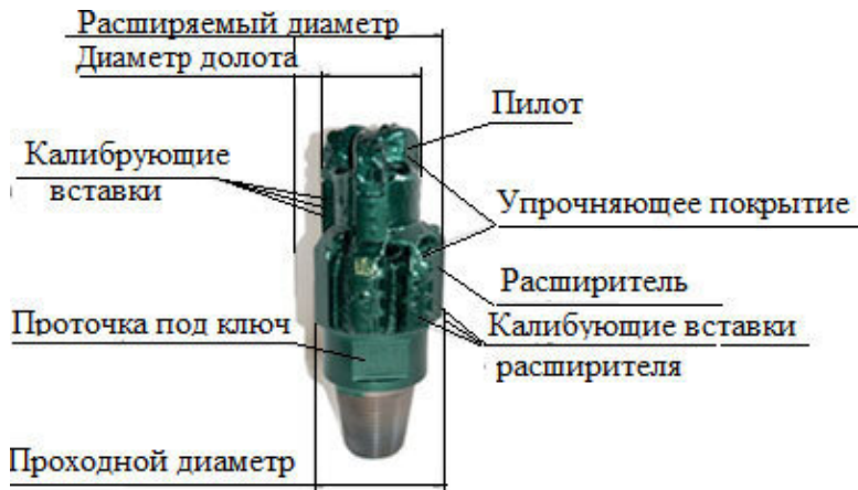
Рис. 5.17. Бицентричное долото
