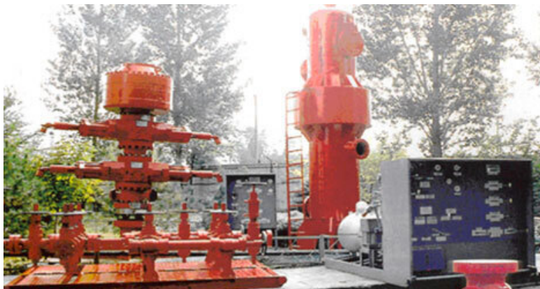
Рис. 2. 14. Превенторная установка
