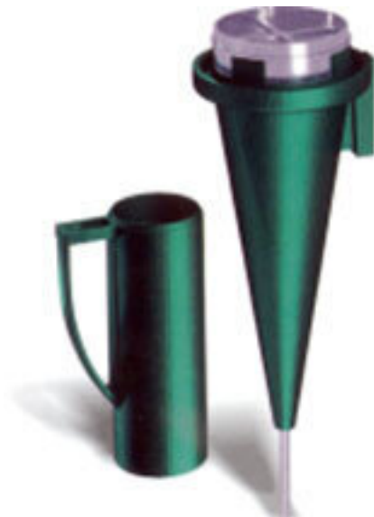
Рис. 8.1. Вискозиметр бурового раствора ВБР-2
