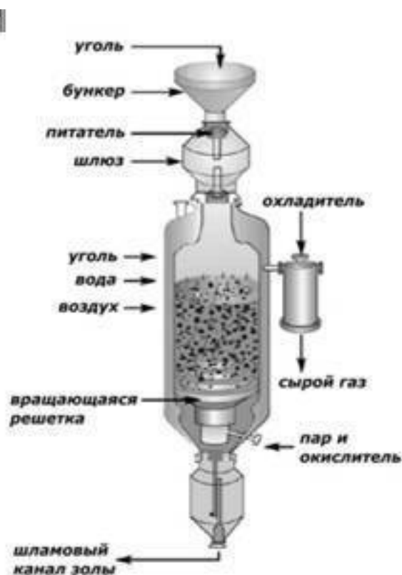
Рис.2.9. Схема газогенератора Лурги
