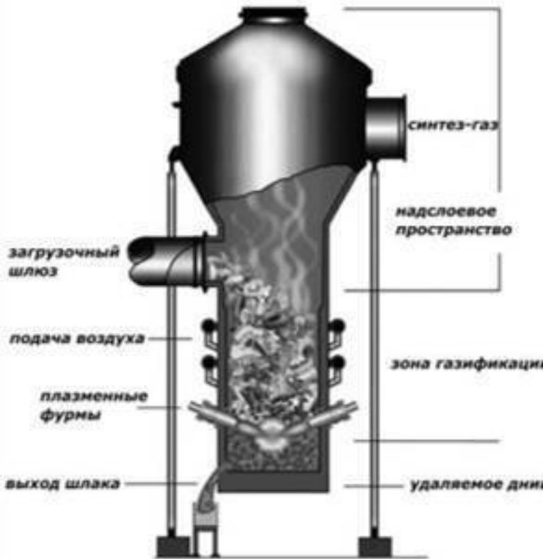
Рис. 2.15. Плазменный газификатор
