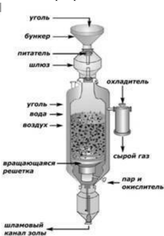
Рис.2.9. Схема газогенератора Лурги
