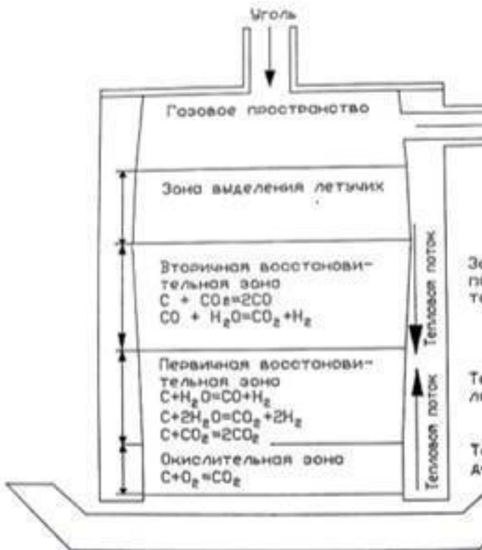
Рис.2.7. Реакционные зоны в газогенераторе
