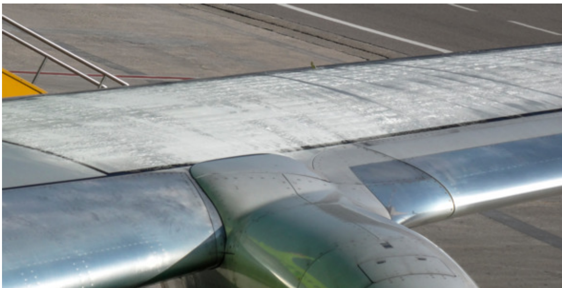
Топливный лёд на верхней поверхности крыла
