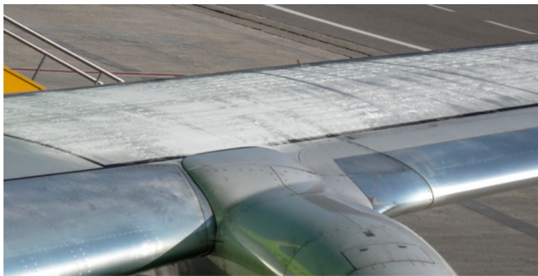
Топливный лёд на верхней поверхности крыла
