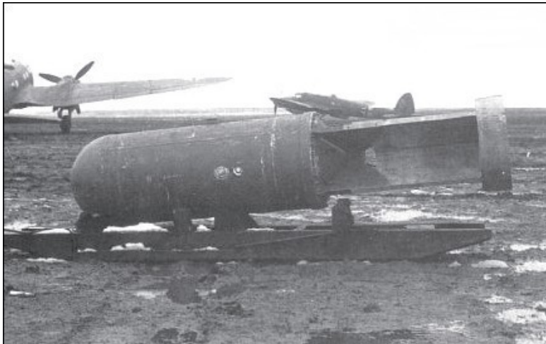
Авиационная мина LMB, подготовленная для сброса без парашюта
