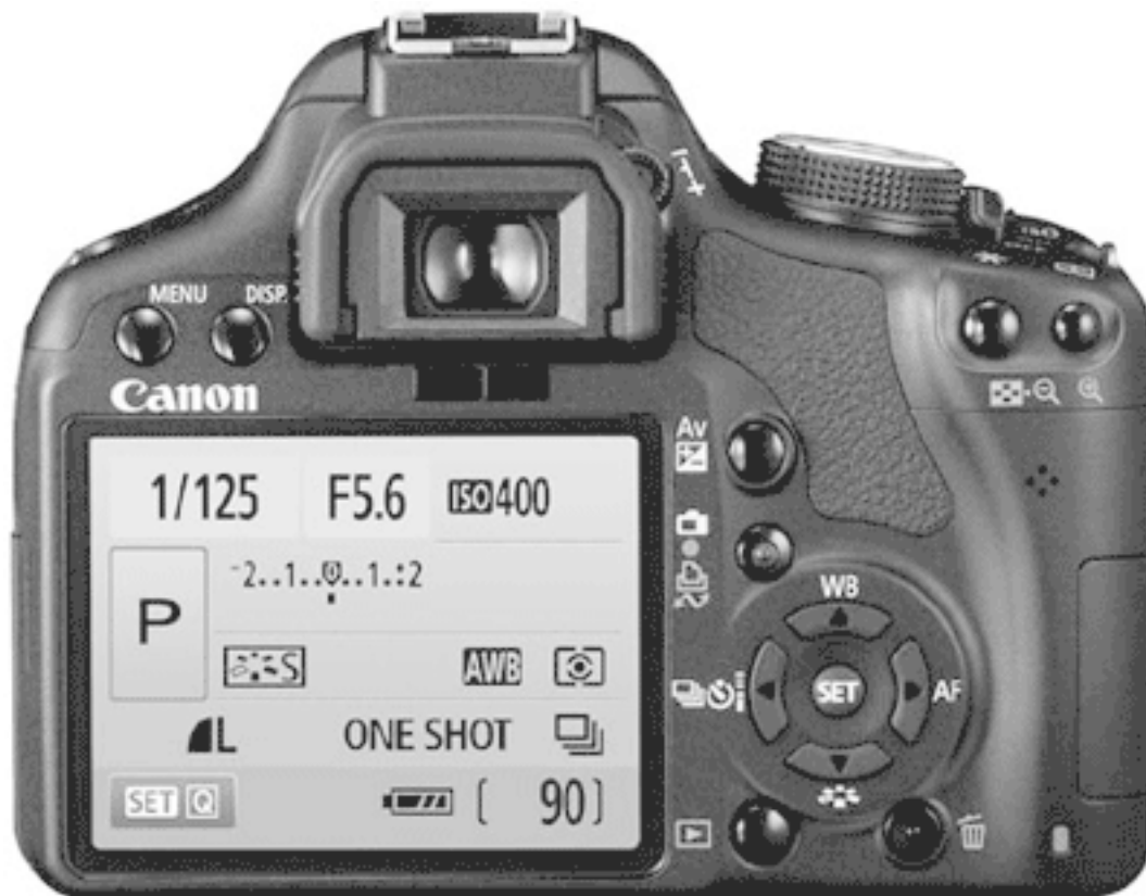
Рис. 1.1. Управляющие элементы камеры Canon EOS 450D
