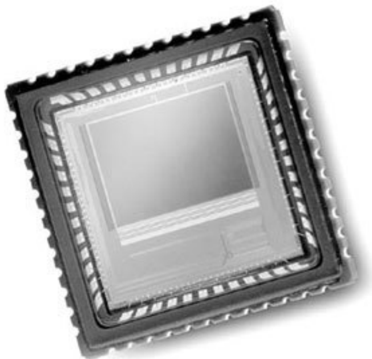
рис. 3.1. Матрица размером 1/1,8" с разрешением 4,5 мегапиксела
