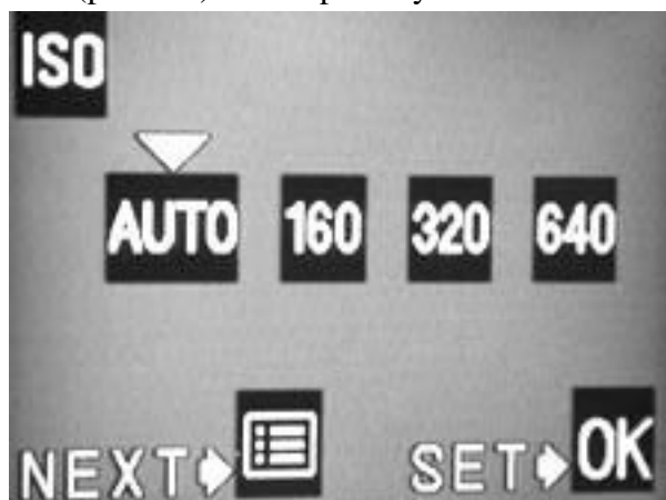
Рис. 3.3. Современные камеры позволяют изменять чувствительность матрицы
