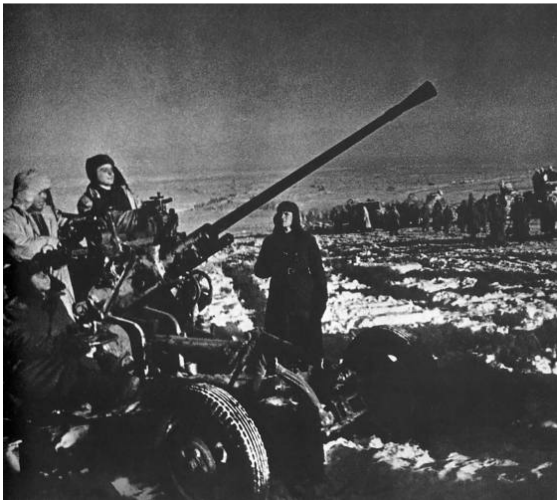
37-мм зенитная автоматическая пушка 61-К обр. 1939 г., район Харькова, зима 1943 г. Войска Красной армии все больше насыщались этими орудиями, пригодными как для отражения атак с воздуха, так и для стрельбы по танкам. Пушка изначально разрабатывалась как противотанково-зенитная.
