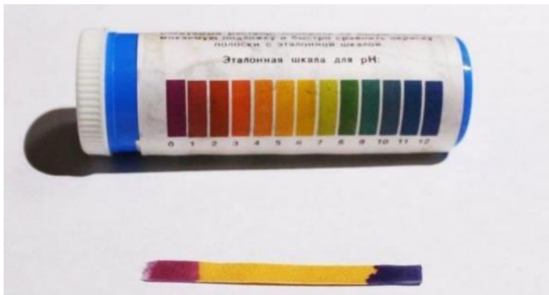
Рис. 2.1. Измерение кислотности почвы: а – прибор для измерения кислотности почвы; б – лакмусовые бумажки.
