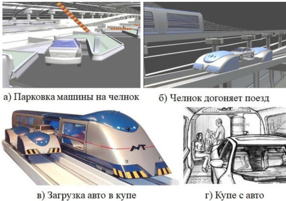
Рис. 1.60. Концепция перевоза автомобиля AVT-Solatrek Trains
