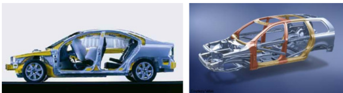
Рис. 1.43. Жесткие элементы и зоны деформации корпуса автомобиля
