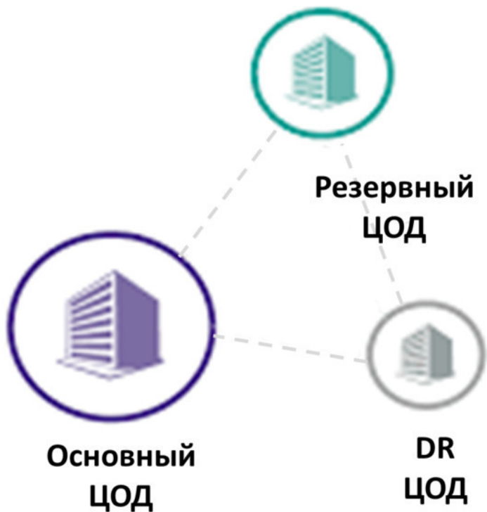
Рис. 1.40. Типовая архитектура резервирования данных
