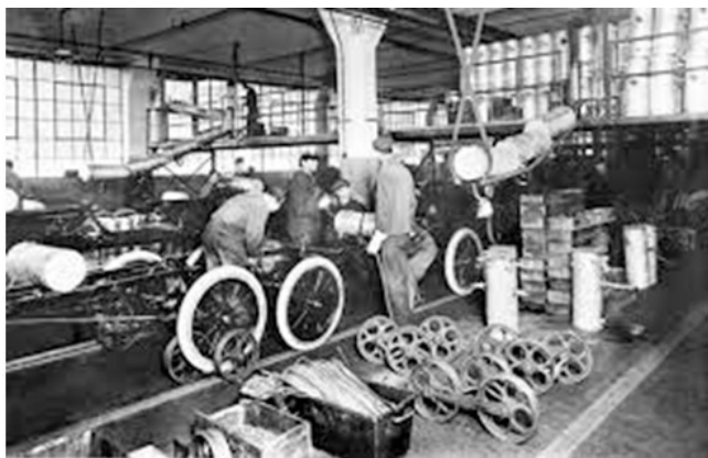
Рис. 1.21. Конвейерное производство автомобилей копа-
