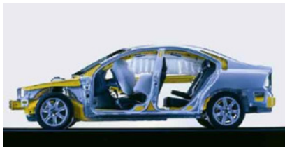
Рис. 1.43. Жесткие элементы и зоны деформации корпуса автомобиля
