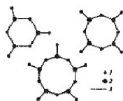
Рис. 19б. Схема строения простейших водных ассоциативов (кластеров): тример, тетрамер и пентамер: 1 – атом водорода; 2 – атом кислорода; 3 – водородная связь
