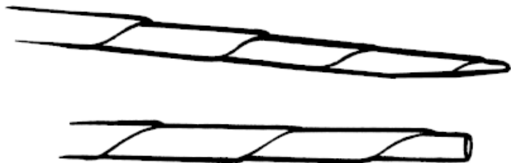
Рисунок 4. Соединение трубочек путем складывания одного конца пополам
