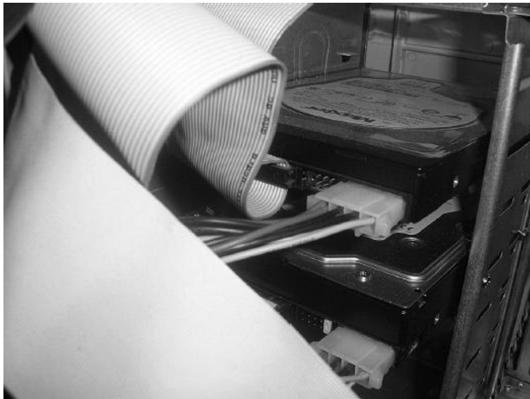
Рис. 6.1. Жесткие диски в корпусе компьютера: один сверху, другой снизу, вроде все понятно?:) Да-да, хотя он и диск, он не круглый. Он похож на коробочку, а точнее, на большую деталь из «Лего», которую «втыкают» в разъемы корпуса компьютера
