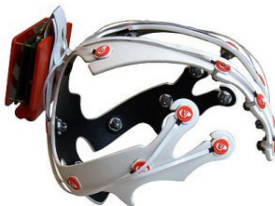
Рис. 23. Шлем на основе ЭЭГ для «чтения мыслей»
