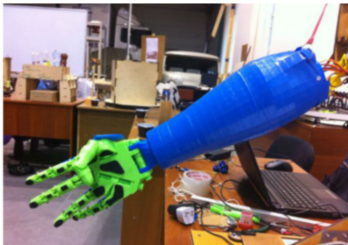
Рис. 14. Бионический протез руки, напечатанный на 3D-принтере
