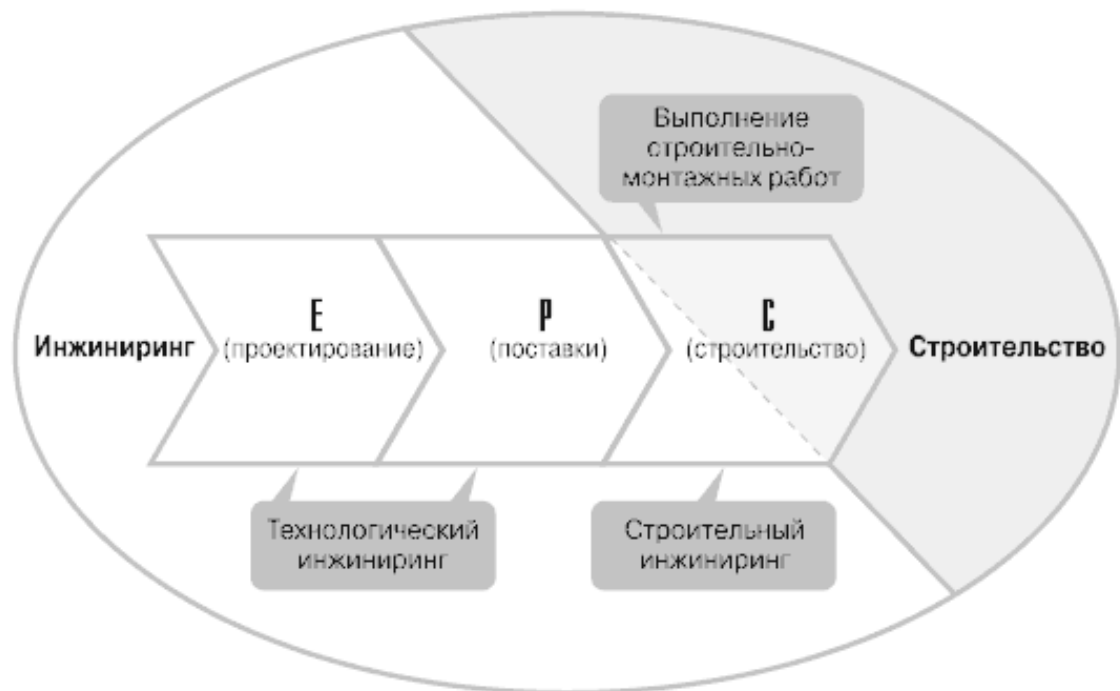
Рис. 2.6.1. Инженерное обеспечение деятельности строителя-подрядчика
