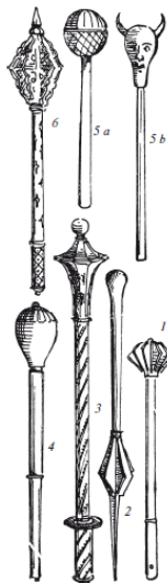
Рис. 2. Примеры булав: 1 – английская булава из дерева и железа, время правления Генриха V (1413–1422). Коллекция Мейрика; 2 – английская булава из железа, середина XV в.; 3 – немецкая булава, железо с гравировкой, длина 56 сантиметров, рукоять обмотана проволокой, XV в. Арсенал Люцерна; 4 – турецкая булава, железо, на верхушке насечками нанесена роза, XV в. Музей артиллерии в Париже; 5 а) – булава из манускрипта конца XV в., копия, иллюстрирована многочисленными миниатюрами из «Шах-Намэ», или «Царской книги», составленной поэтом Фирдоуси в период правления Махмуда (999). Мюнхенская библиотека; 5 b) – то же самое; 6 –
