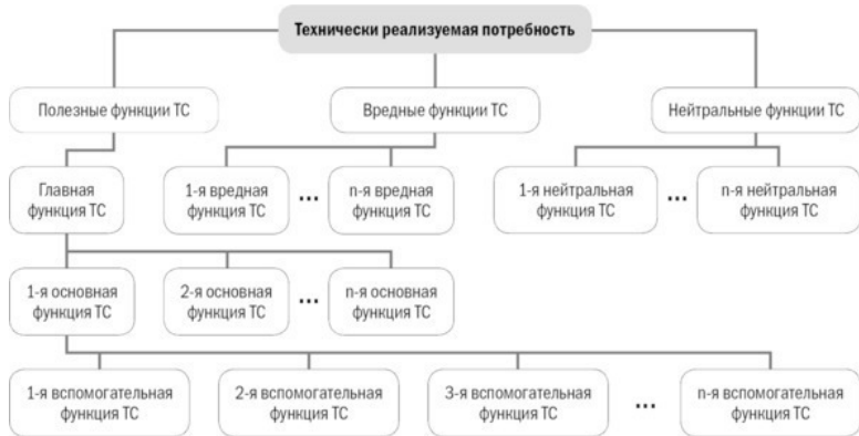
Рисунок 16. Преобразования технически реализуемой потребности в различные виды функций ТС
