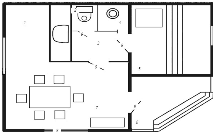
Рис. 5. План размещения бани с совмещением предбанника и моечной с санузлом: 1 — кухня; 2 — туалет; 3 — раздевалка; 4 — душевая; 5 — парильня; 6 — веранда; 7 — жилая комната; 8 — окно; 9 — двери
