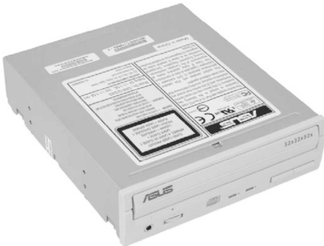
Рис. 1.7. Привод для CD или DVD
