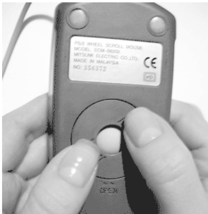
Рис. 2.2. Открываем посадочное гнездо и вынимаем шарик
