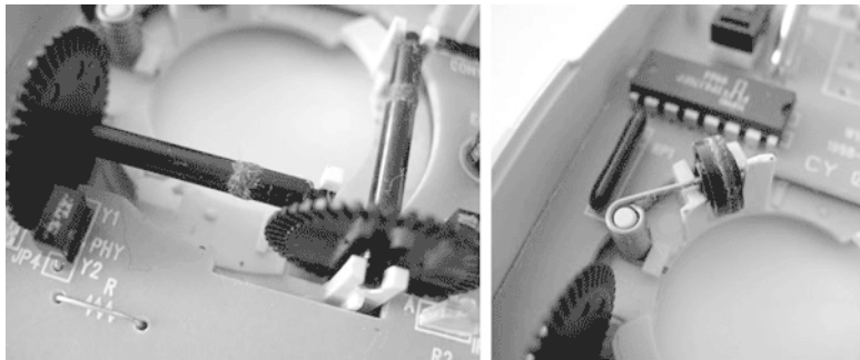
Рис. 2.3. Очищаем валики ( слева ) и прижимной вал ( справа ) от прилипшей грязи
