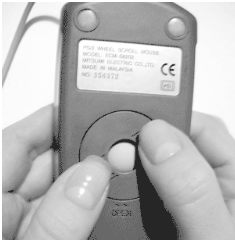
Рис. 2.2. Открываем посадочное гнездо и вынимаем шарик
