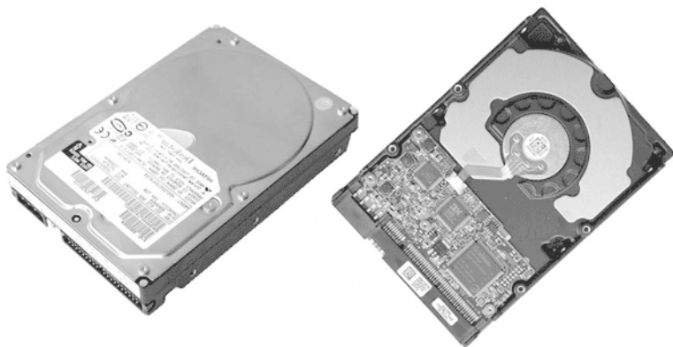
Рис. 1.6. Винчестер: вид сверху и снизу
