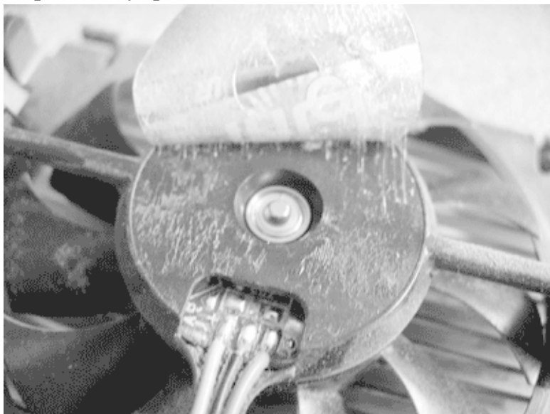
Рис. 2.5. Отклеиваем наклейку и снимаем пластиковое кольцо
