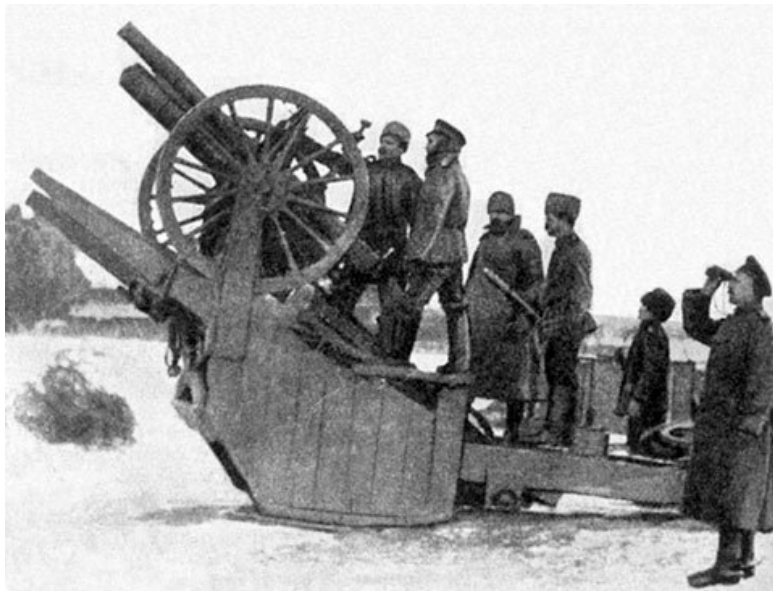
Установленная на специальном станке 3-дюймовая пушка обр. 1902 г., Путиловского завода, приспособленная для стрельбы по воздушным целям. 1916 г.
