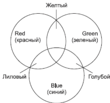
Рис. 2.1. Схема цветовой модели RGB
