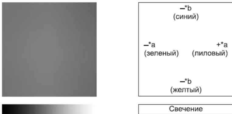
Рис. 2.3. Схема цветовой модели L^*a^*b
