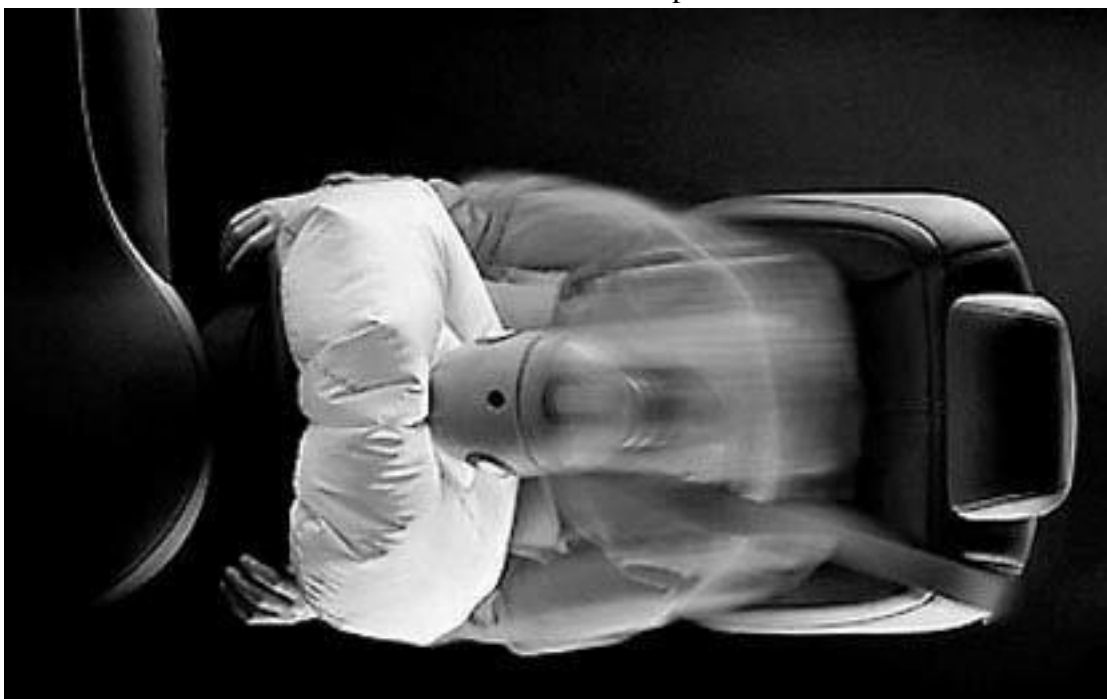
На этот раз подушка безопасности защитила манекен
