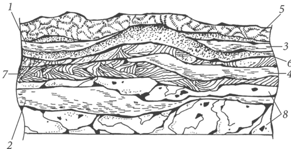
Рисунок 2. Схема образования подземных вод: 1, 3) грунтовые воды; 2) артезианская вода; 4) межпластовые воды; 5) поверхностный слой грунта; 6) песчаный и каменистый слой; 7) глиняный водоупорный горизонт; 8) известняки
