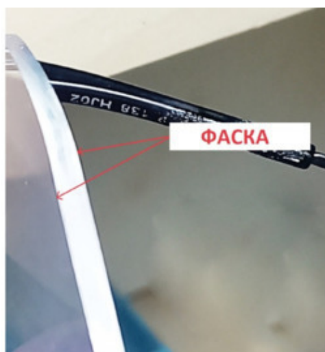
Рис. 14. Ребро линзы под безободковую модель
