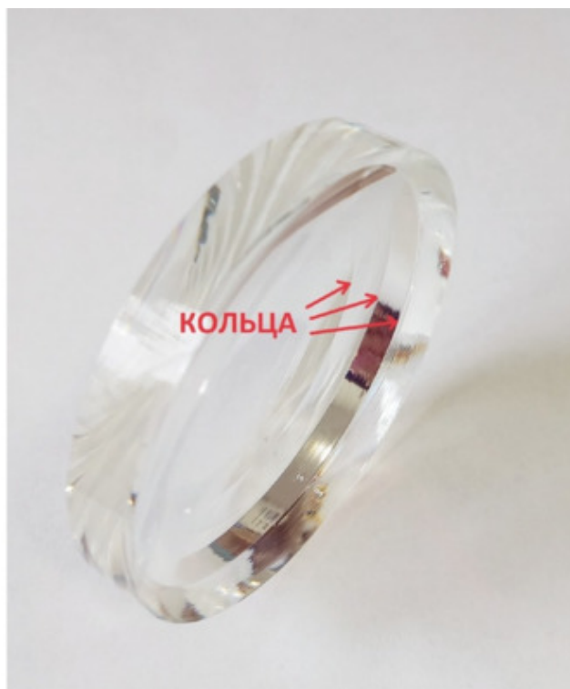
Рис. 30. Аберрации задней части линзы
