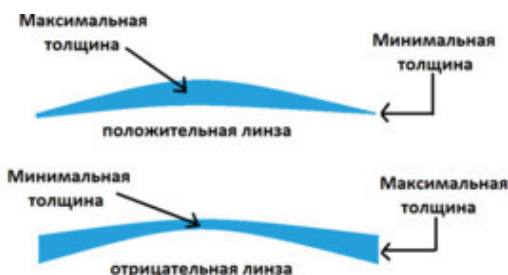
Рис. 16. Положительная и отрицательная линзы
