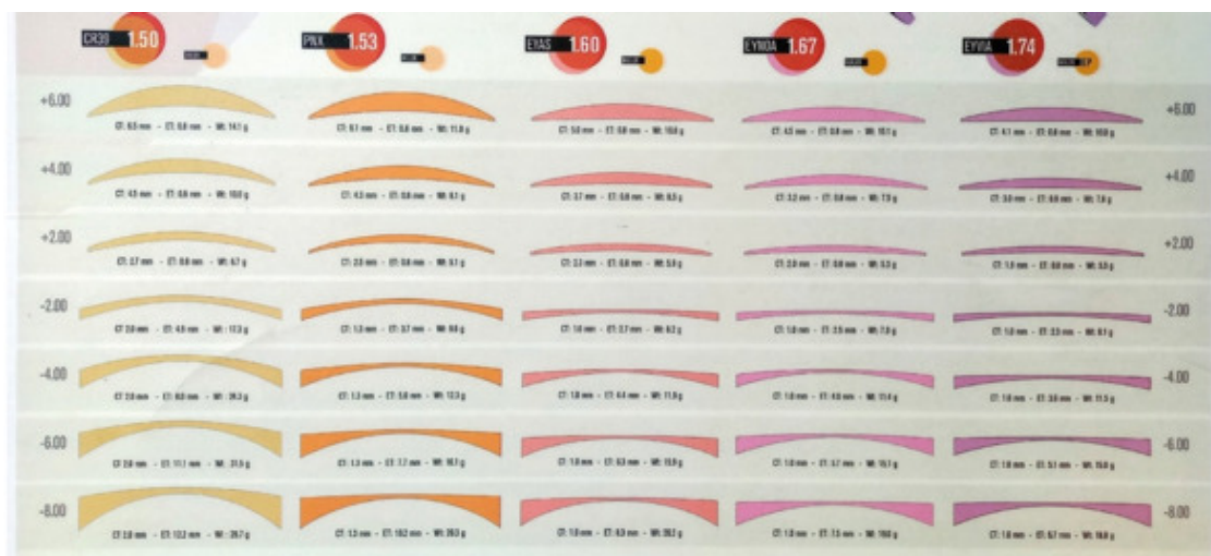
Рис. 17. Влияние индекса преломления на толщину линз
