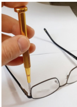
Рис. 4. Фиксация линзы болтом
