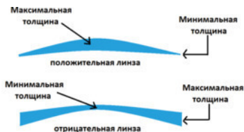
Рис. 16. Положительная и отрицательная линзы
