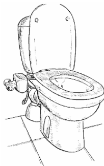
Рис. 4. Унитаз-компакт со специальным устройством для слива воды.
