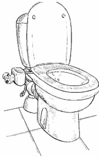
Рис. 4. Унитаз-компакт со специальным устройством для слива воды.
