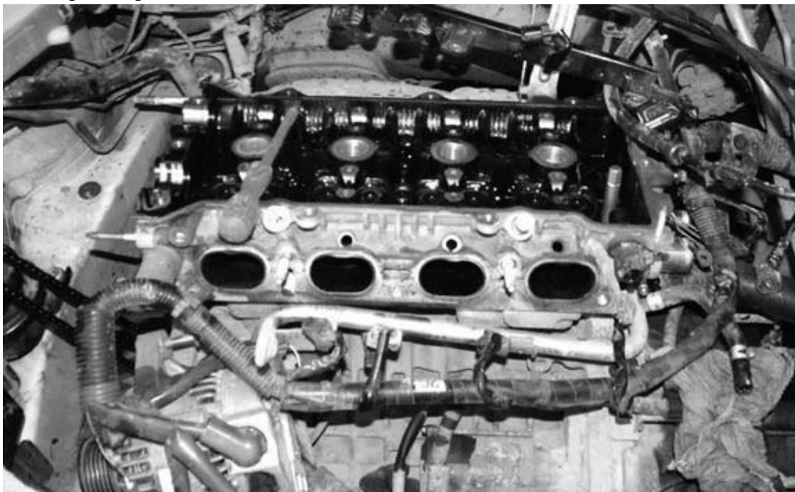
Рис. 1.2. Двигатель со снятой головкой блока цилиндров
