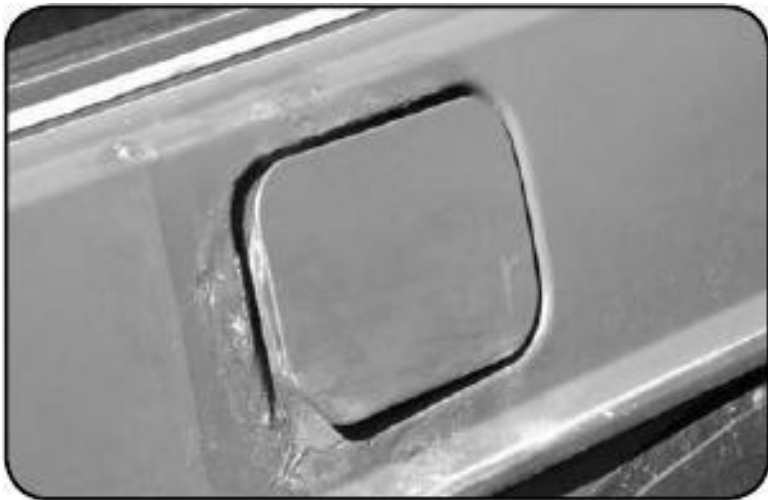
Рис. 1.7. Коррозия лючка заправочной горловины бензобака и прилегающей части крыла
