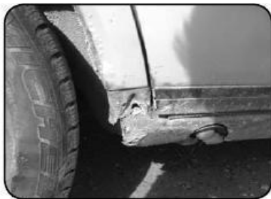
Рис. 1.5. Наиболее подверженные коррозии участки автомобиля: а – колесные арки; б – молдинги и декоративные накладки
