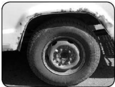
Рис. 1.5. Наиболее подверженные коррозии участки автомобиля: а – колесные арки; б – молдинги и декоративные накладки
