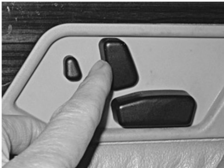
Рис. 1.7. Хорошая проекция: регулятор положения автомобильного кресла
