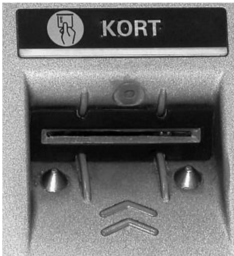
Рис. 1.6. Вот пример скиммера
