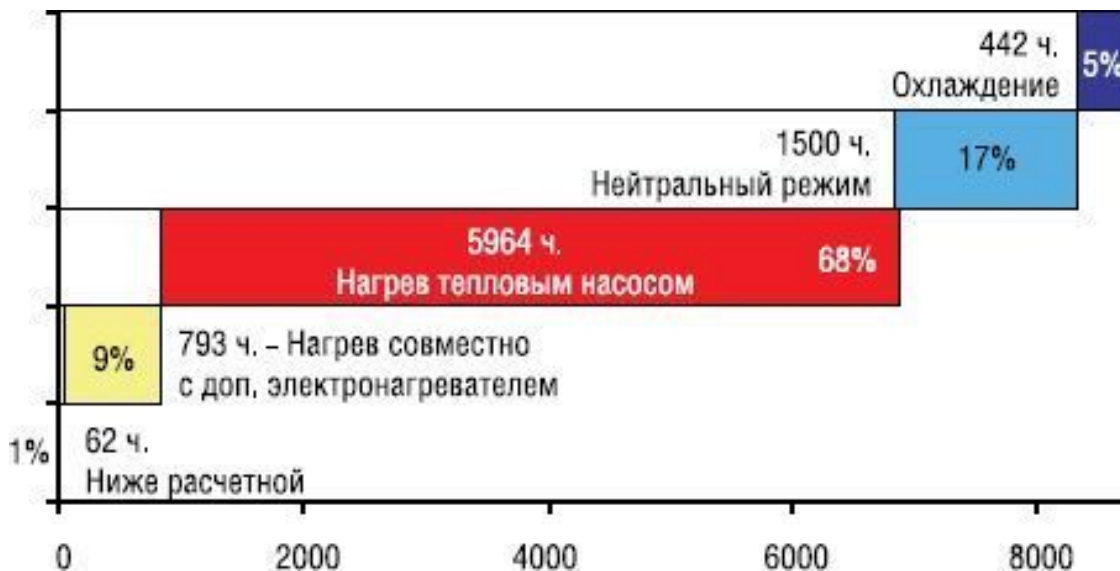
Рис. 5. Распределение функций воздушного теплового насоса во Франкфурте-на-Майне
