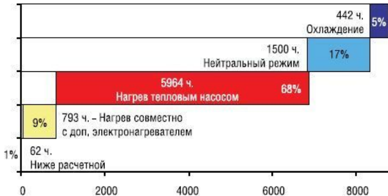
Рис. 5. Распределение функций воздушного теплового насоса во Франкфурте-на-Майне
