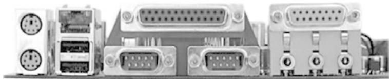
Рис. 1.19. Разъемы интерфейсов на системной плате
