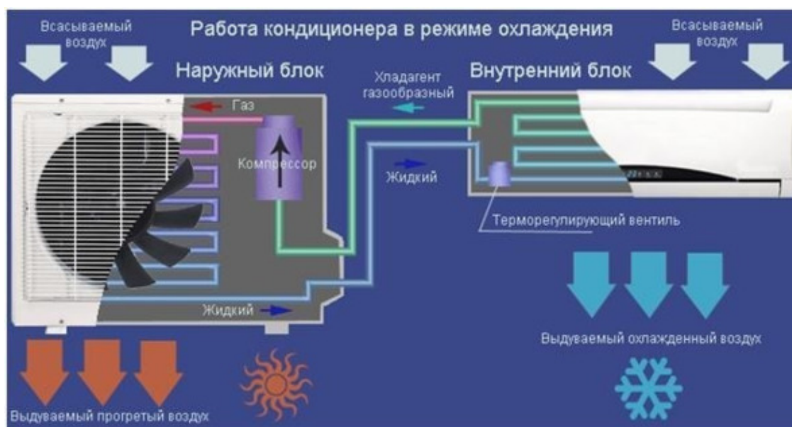
Рис. 3.15. Принцип работы кондиционера в режиме охлаждения 11
