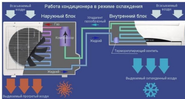
Рис. 3.15. Принцип работы кондиционера в режиме охлаждения 11
