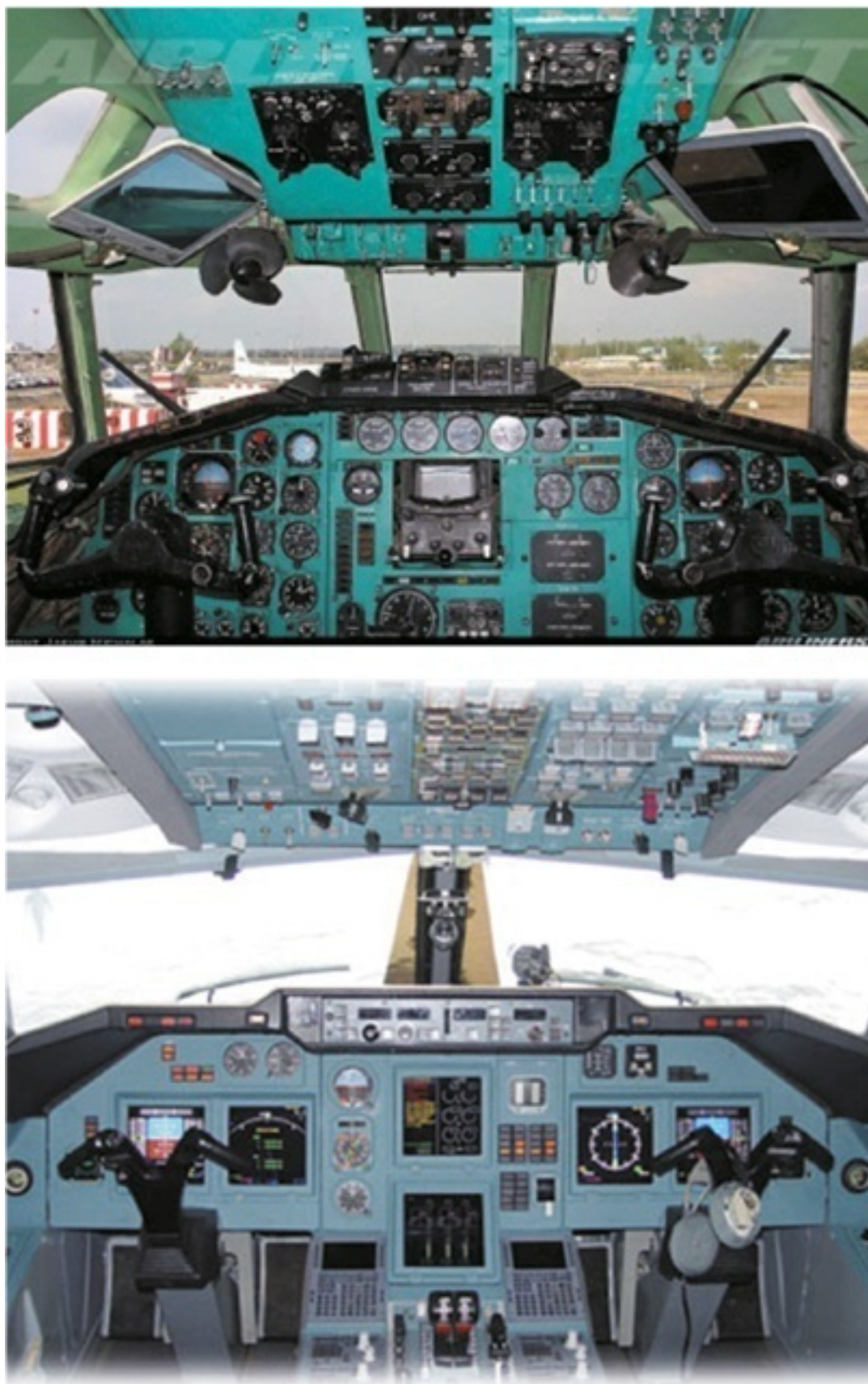
Рис. 1.7. Кабина пилотов устаревшего ТУ-154 (сверху) и современного ИЛ-96 (снизу)
