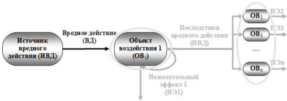
Рис. 5.12. Изоляция нескольких объектов воздействия
