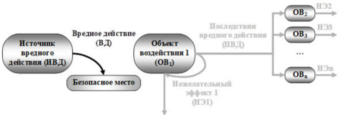
Рис. 5.16. «Оттягивание» вредного действия
