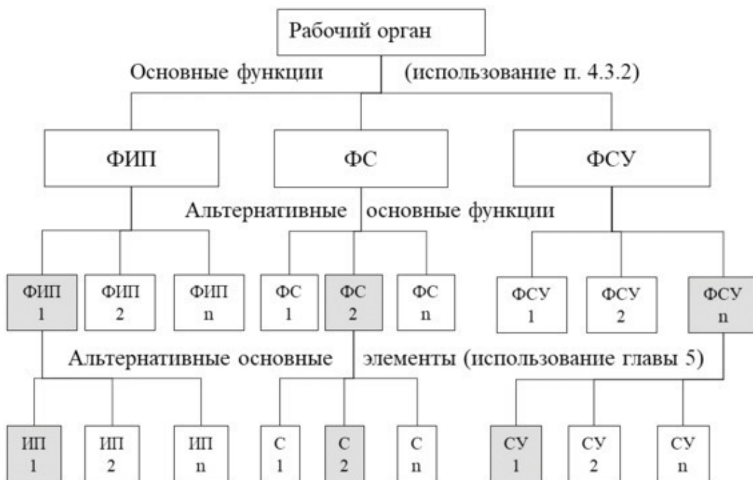
Рис. 7.6. Граф выбора источника и преобразователя, связей и системы управления
