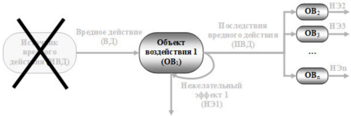
Рис. 5.7. Ликвидация источника вредного действия
