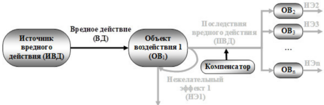
Рис. 5.15. Компенсация последствий вредного действия воздействием на последствия вредного действия
