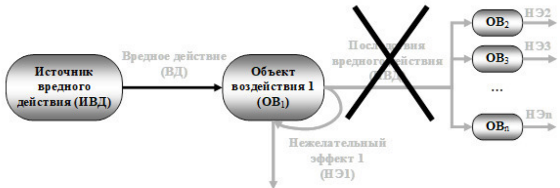
Рис. 5.9. Ликвидация последствий вредного действия
