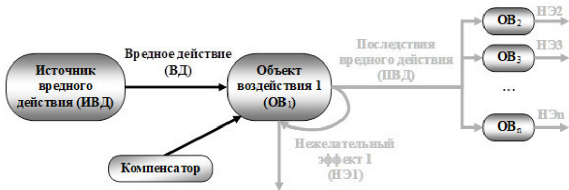
Рис. 5.13. Компенсация вредного действия воздействием на объект
