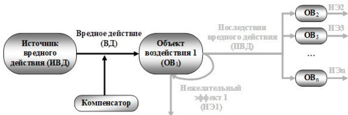
Рис. 5.14. Компенсация вредного действия воздействием на вредное действие
