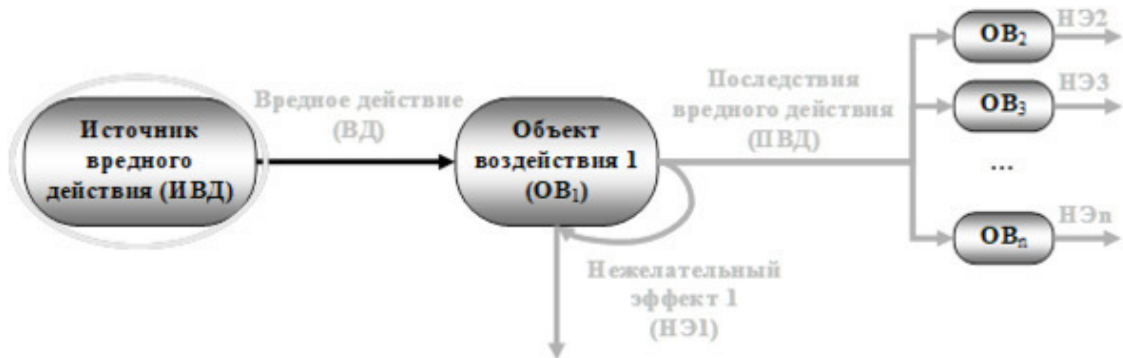
Рис. 5.10. Изоляция источника вредного действия
