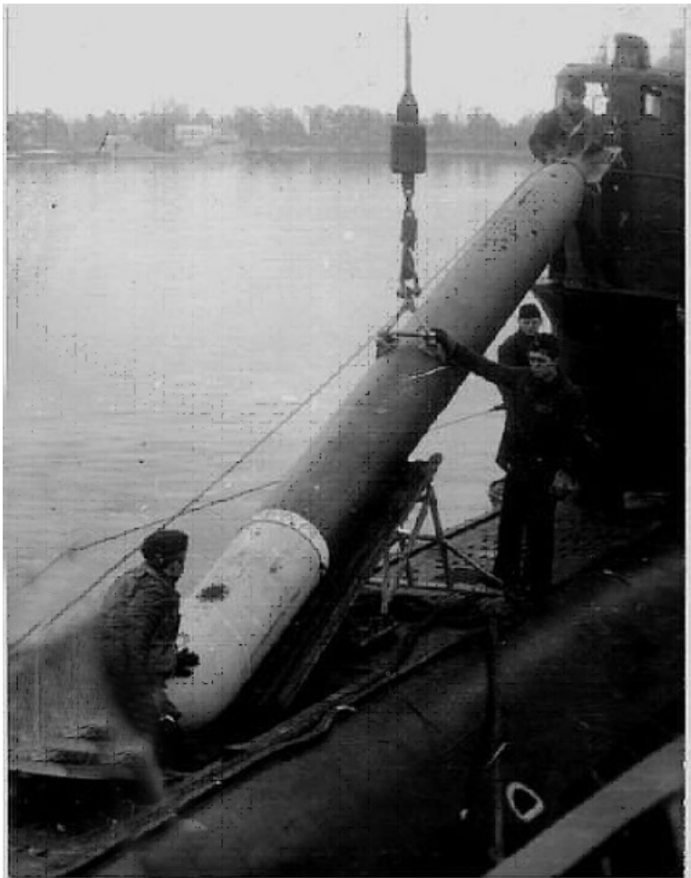
Выгрузка торпеды из носового отсека
