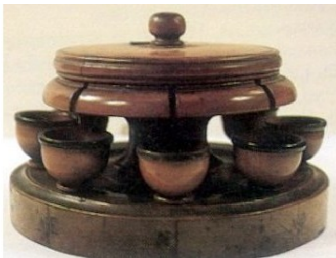
Прибор для фиксации землетрясений Николы Кассиоторы, 1818 год (из архива автора).
