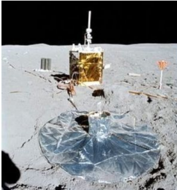
Сейсмостанция экспедиции «Аполлон-17» на Луне (NASA, Public Domain).
