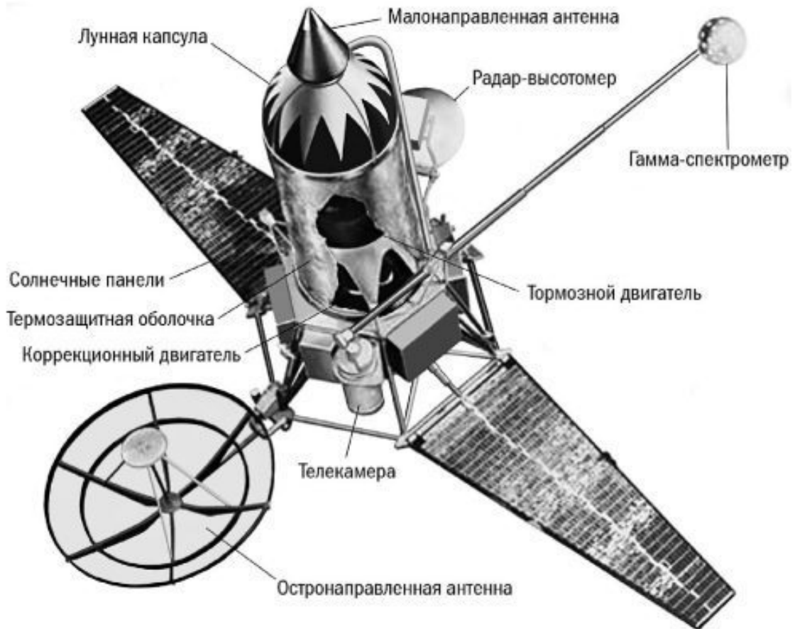
Рис. 1.13. Зонды «Рейнджер-3...5» должны были не только передавать изображения лунной поверхности, но и доставить на нее сейсмометры, заключенные для амортизации удара в шарообразный деревянный контейнер.
