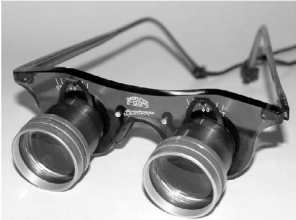
Рис. 1.26. Цейссовский театральный бинокль, оформленный в виде очков, – прямой потомок телескопа Галилея.
