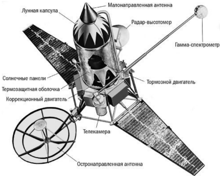
Рис. 1.13. Зонды «Рейнджер-3...5» должны были не только передавать изображения лунной поверхности, но и доставить на нее сейсмометры, заключенные для амортизации удара в шарообразный деревянный контейнер.
