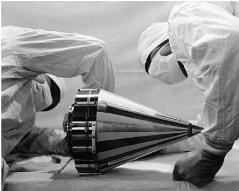
Рис. 1.12. Подготовка «Пионера-3», запущенного 6.XII.1958 в сторону Луны четырехступенчатой ракетой «Джунго II» (на основе баллистической ракеты «Юпитер») с мыса Канаверал во Флориде.
