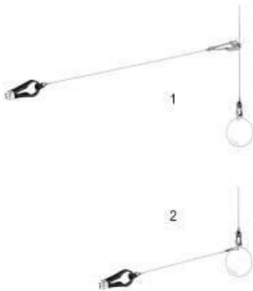
Рис. 9. Расположение «прищепок» на тросе даунриггера: 1 – при ловле в толще воды; 2 – при донной ловле.
