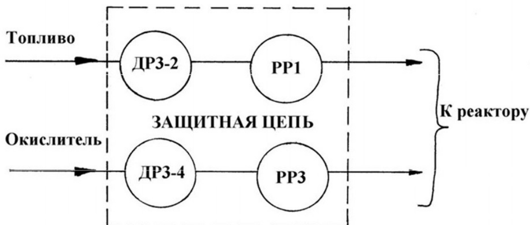
Рис. 2.5. Структурная схема защитной цепи
