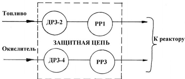
Рис. 2.5. Структурная схема защитной цепи
