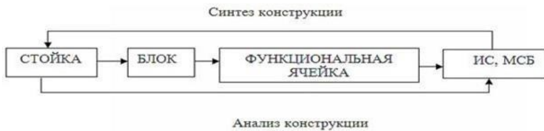
Рис. 2. Принцип системности в процессе конструирования
