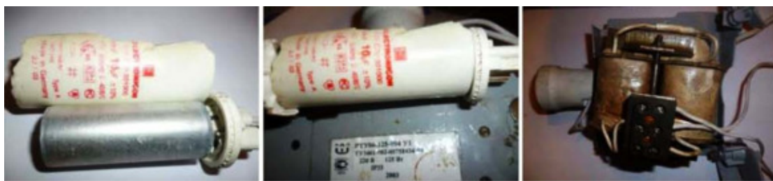
Фото 3.7. Вырванный со столба фонарного освещения разбитый механически блок преобразования для питания лампы освещения.
