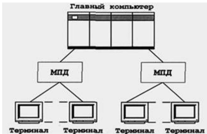
Рис.2.5. Архитектура "Терминал-главный компьютер"
