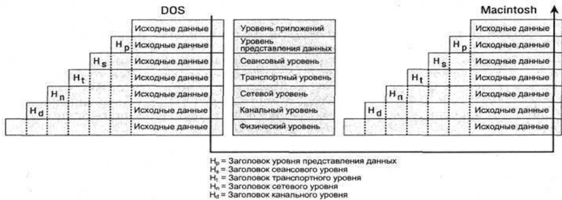
Рис. 3.8. Когда пакеты проходят вверх и вниз по стекам, каждый уровень добавляет или удаляет соответствующую управляющую информацию
