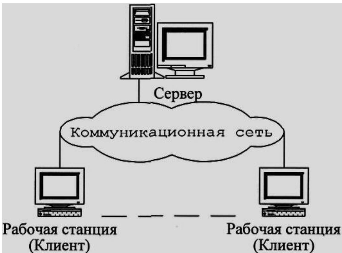
Рис.2.6. Архитектура "Клиент-сервер"
