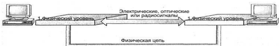
Рис. 3.9. Физический уровень создает физическую цепь для передачи электрических, оптических или радиосигналов
